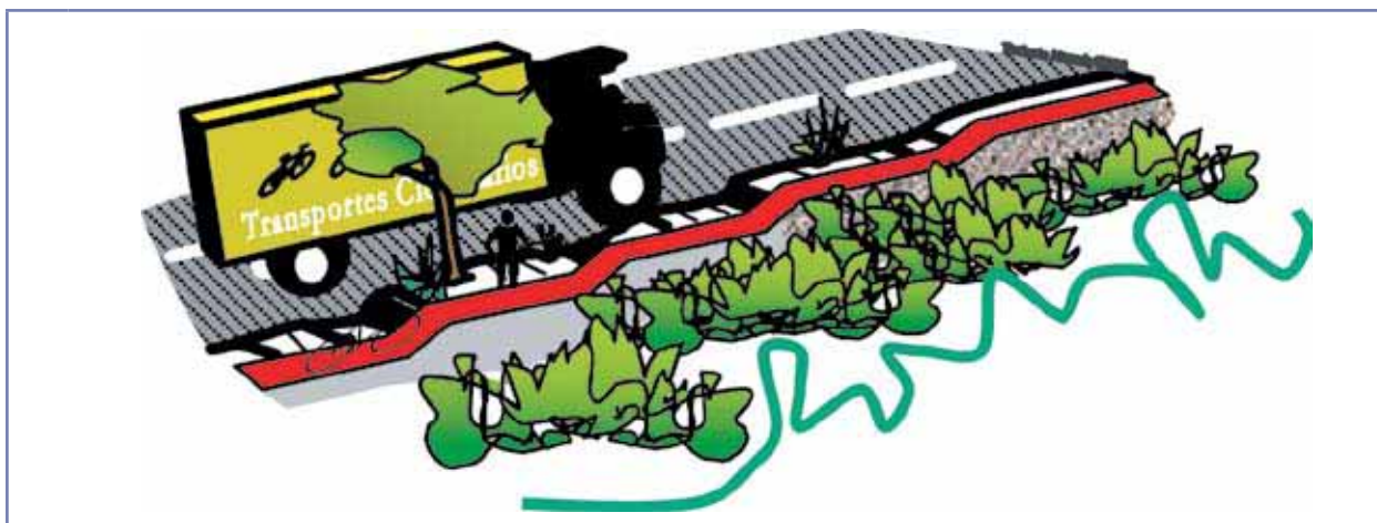
FIGURA 104 - Trecho de projeto de ciclovia em patamares ao lado de uma rodovia.
